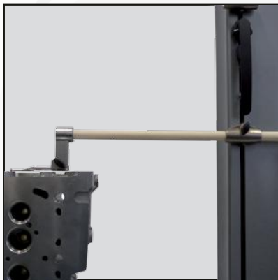
Colonne Trimos avec support pour touche longue mesurant une pièce..
