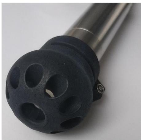
La crépine de protection, en nylon, se positionne sur la tête du capteur afin de protéger la membrane active (DODisk) du capteur OPTOD.
