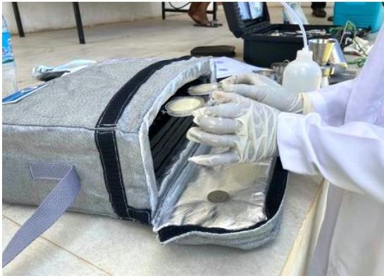
2 - Incubez vos échantillons microbiologiques pendant 24 heures à 37°C. L'incubateur maintient une température parfaite sans électricité ni piles.
