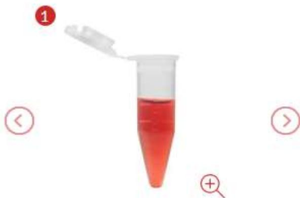
Les tubes à réaction LABSOLUTE® 5 ml avec bouchon à encliqueter attaché sont les tubes parfaits pour travailler avec des volumes allant jusqu'à 5 ml. Pour les incubations supérieures à 80 °C, il est recommandé de fermer le tube avec la pince (7.696 749).
