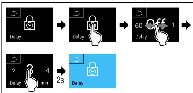
Fig. 127 Il est possible de régler les valeurs suivantes : Off (pas de délai d'attente) jusqu'à 60 minutes ; par intervalles de 1 minute
