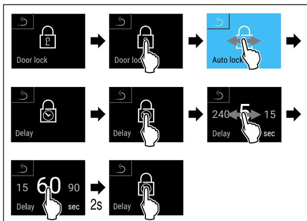
Fig. 121 Il est possible de régler les valeurs suivantes : 5, 15, 60, 90, 120, 180 et 240 secondes
