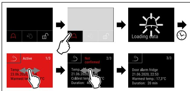
Fig. 268 L'exemple montre une alarme active, une alarme pas encore confirmée et une alarme confirmée.
