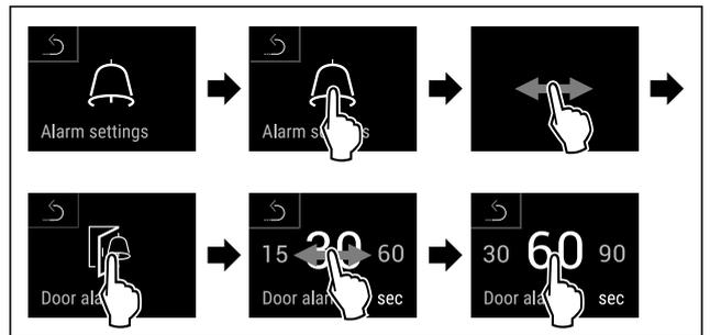
Fig. 220 Représentation à titre d'exemple : modification de l'alarme de porte de 30 secondes à 60 secondes.
