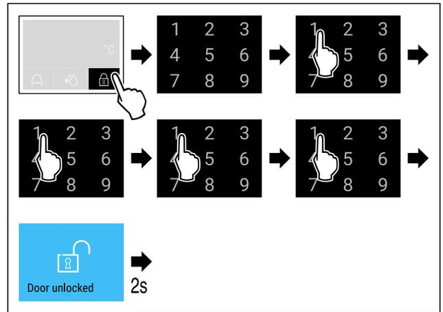
Fig. 114 Déverrouillage de la porte avec le code de porte 1 1 1 1.
