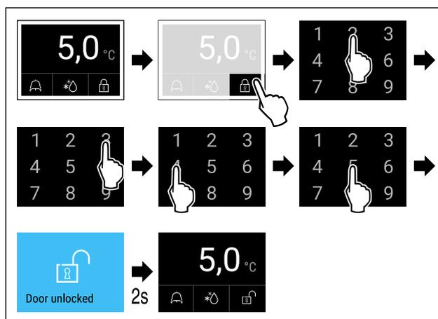
Fig. 265 L'exemple montre le code PIN 2345
