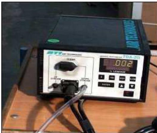
**Figure 4.** Résultat correct : aucune fuite
