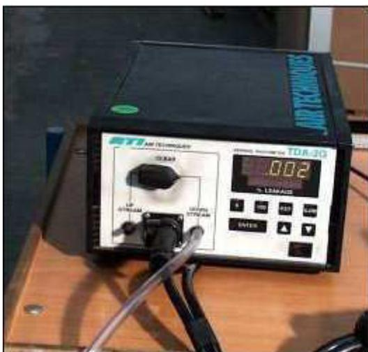
**Figure 5.** Résultat correct : aucune fuite
