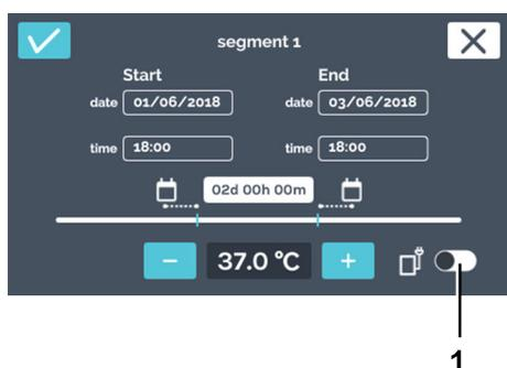
Fig. 112 : Activer le contrôle de contact électrique
