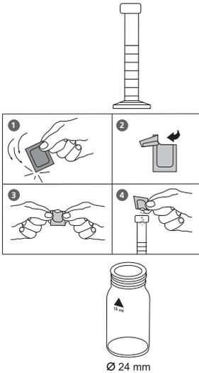
1. Verser **20 ml d'échantillon** dans une éprouvette graduée avec bouchon propre de 25 ml.
