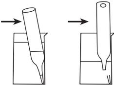
1. Placer dans la chambre de mesure l'ampoule zéro fournie dans le kit d'essai.
