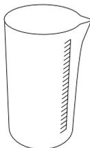
1. Rincer une seringue de 5 ml à plusieurs reprises avec la solution à analyser et la remplir jusqu'à la graduation 5 ml en évitant la formation de bulles d'air. Verser ces 5 ml dans un récipient gradué propre de 100 ml. Compléter jusqu'à la graduation 100 ml avec de l'eau sans chlore (eau déminéralisée) et mélanger avec un agitateur propre.
