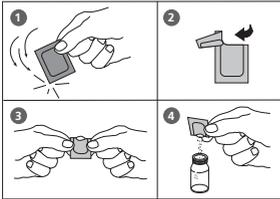
1. Ouvrir une cuvette de réactif à couvercle blanc et la remplir de **2 ml d'eau déminéralisée** (cuvette étalon).
