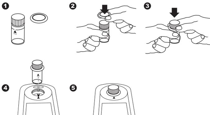
5. Le couvercle de la cuvette doit être fermé lors du calage du zéro et pendant le test. Il doit être pourvu d'un joint d'étanchéité.
