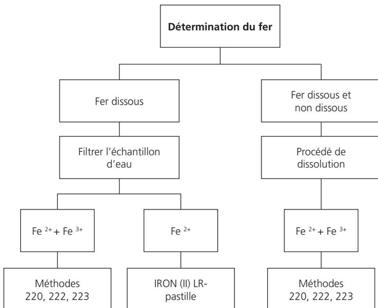
**Procédé de minéralisation** pour la détermination du fer totalement dissous et non dissous:
