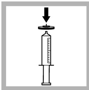
3. Attachez solidement le filtre à l'embout conique de la seringue.
