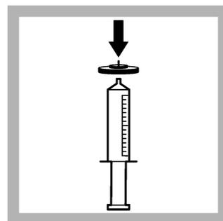
8. Fixez solidement le filtre adaptable préparé sur le raccord Luer de la seringue.
