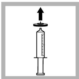
6. Retirez le filtre adaptable de la connexion Luer de la seringue.
