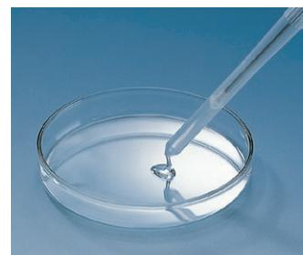
Le Transferpettor est l'appareil idéal pour pipetter les milieux de viscosité élevée, comme les solutions protéiques très concentrées, les huiles, les résines ou les graisses, ayant une viscosité jusqu'à 50 000 mm<sup>2</sup>/s. Les milieux de densité élevée allant jusqu'à 13,6 g/cm<sup>3</sup>, comme la glycérine, le mercure, l'acide sulfurique, etc., peuvent être dosés sans modification de calibration.
