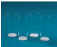
Jeu de tubes échantillons en verre avec fritte pour B-811 (4 pièces)
