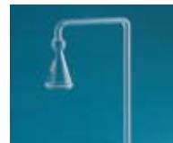
Tube d'aspiration d'échantillon
